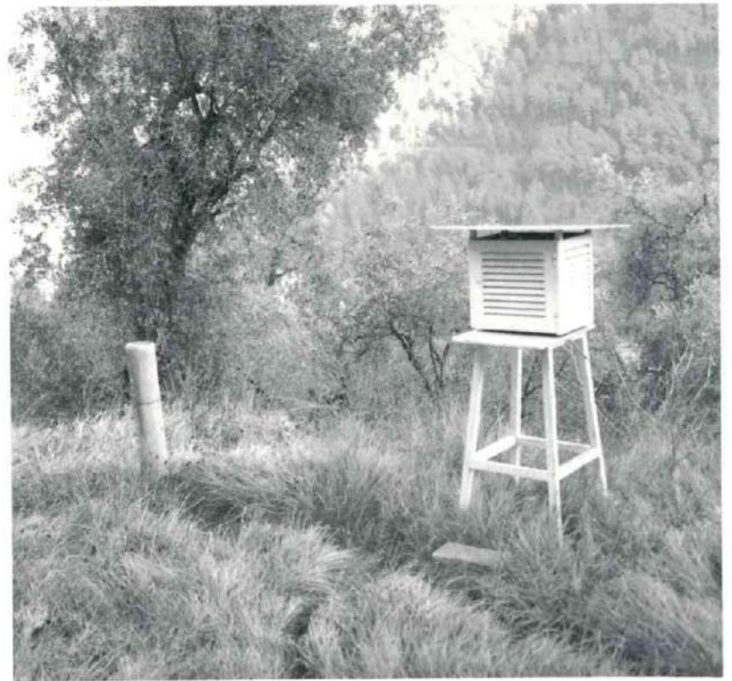
Voici une station météorologique caractéristique, implantée dans les oliviers breillois par les services de bioclimatologie d'Avignon, dont le responsable est M. Baldy. Sur place, les relevés sont effectués par M. Marcuccini. On distingue à l'intérieur de l'appareil un thermo-hygromètre enregistreur mensuel, et deux thermomètres: un à maximum (à mercure) et un à minimum (à alcool).
