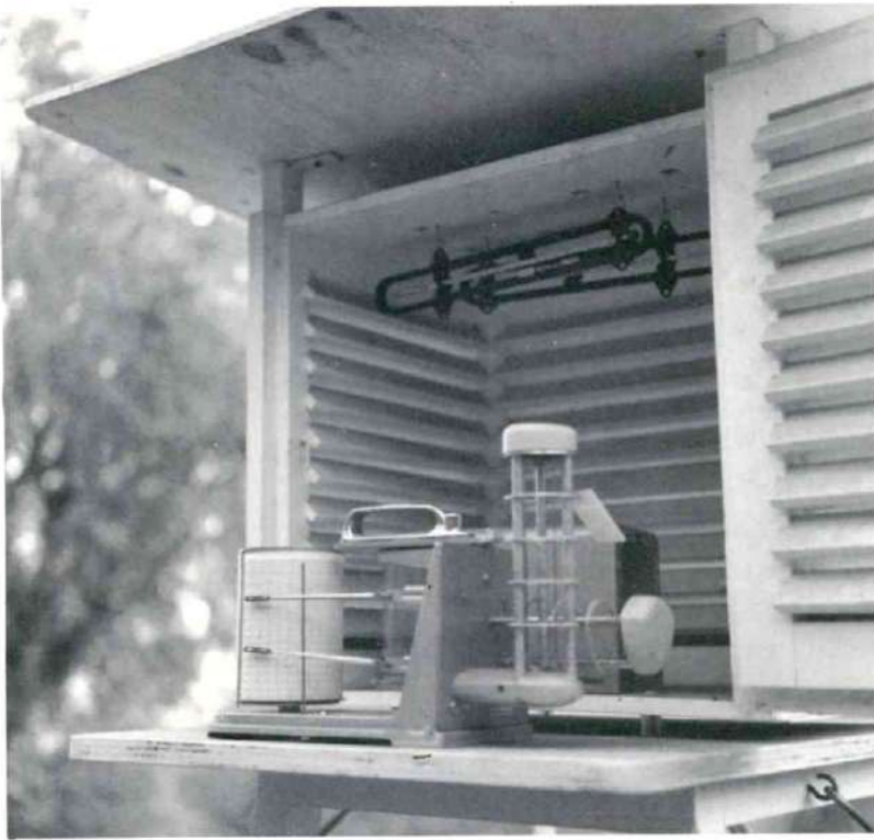
Voici une station météorologique caractéristique, implantée dans les oliviers breillois par les services de bioclimatologie d'Avignon, dont le responsable est M. Baldy. Sur place, les relevés sont effectués par M. Marcuccini. On distingue à l'intérieur de l'appareil un thermo-hygromètre enregistreur mensuel, et deux thermomètres: un à maximum (à mercure) et un à minimum (à alcool).
