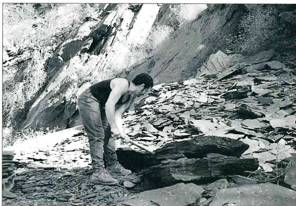
Ci-dessus, les outils du bâtisseur de murets de Breil. A droite, la marque des anciens forages à la barre à mine pour désolidariser les blocs à la carrière de Scarassoui. Ci-contre, Serge Franca en train d'effeuiller un bloc de schiste pour en tirer des «ciappe». Photos José BANAUDO & José CAZAJUS
